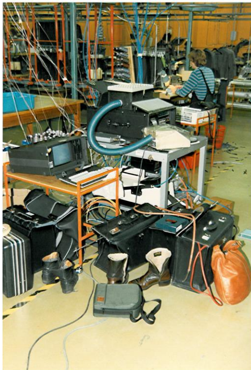
Kuvassa on Seppo Heinäsen virittämä ja Arto Laaksosen ohjelmoima monipuolinen ilmanvaihdon tehokkuuden mittaustilasto. Tässä tutkittiin ompelimon ilmanvaihdon tehokkuutta eli hyötysuhdetta (AX).
