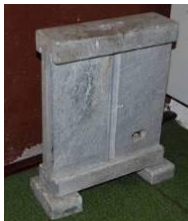
Jo 1940-luvulla oli lämpöä varaavia vuolukivestä tehtyjä sähkölämmityspattereita (BHa). Teho ja koko olivat vaatimattomat ja vastukset paloivat herkästi poikki. Tehoa ohjattiin irrottamalla pistotulppa tai varustamalla liitäntäjohto katkaisimella.
