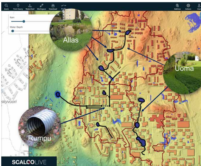
Kuva 5. Varissoon valuma-alueella on pitkälti hyödynnetty olemassa olevia virtausreittejä, joihin on lisätty altaita tulvavesien varastointiin ja viivyttämiseen.
