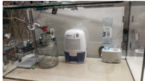
Kuva 3. Tutkittava aine sijoitettiin kammion pohjalle lasivatiin. Kammioilmaa kostutettiin ultraäänihöyrystimellä. Kammion ilman kosteus tiivistettiin Peltier-kuivaimella vedeksi. Kammiossa mitattiin jatkuvatoimisesti lämpötilaa, kosteutta ja TVOC-pitoisuutta. Samassa kammiossa testattiin reaaliaikaista kondenssiveden pintajännitysmittausta kuvassa oleva lasipurkin päällä olevalla laitteistolla.
