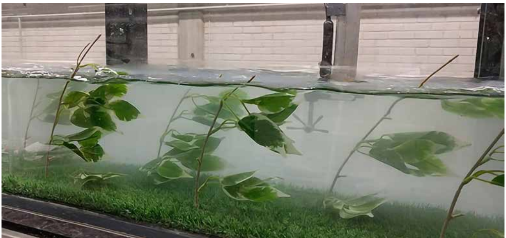
Kuva 2. Aalto-yliopistossa luontopohjaisia ratkaisuja tutkitaan niin laboratoriovirtauskouruja, kenttämittauksia kuin numeerista mallinnusta hyödyntäen. Kourumittauksilla voidaan selvittää fysikaalisia virtaus-, kulkeutumis- ja pidättymisilmiöitä hallituissa olosuhteissa, kun kenttämittauksilla parannetaan ymmärrystä virtauksen ja biologisten sekä kemiallisten prosessien välisistä vuorovaikutuksista.
