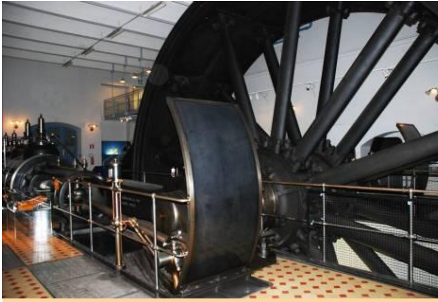
Tampereen Finlaysonille rakennettiin 1800-lopulla Pohjoismaitten suurin höyryvoimakeskus, jolla pyöritettiin koneita, pumppuja ja puhaltimia. Jokaisen tekniikan ihmisen yleissivistykseen kuuluvan koneikon voi nähdä ilmaiseksi Työväen Museo Werstaalla Tampereella. (BHa)
