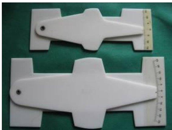
Alkuperäinen Arto Laaksonen kehittämä ilmanvaihtoventtiilin avautuman mittatulkki 1970-luvun loppupuolelta. Kuva Laaksonen ottama.
